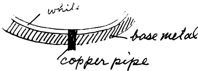
図 51 クロスヘッド・ピン軸受給油孔への銅管圧入
