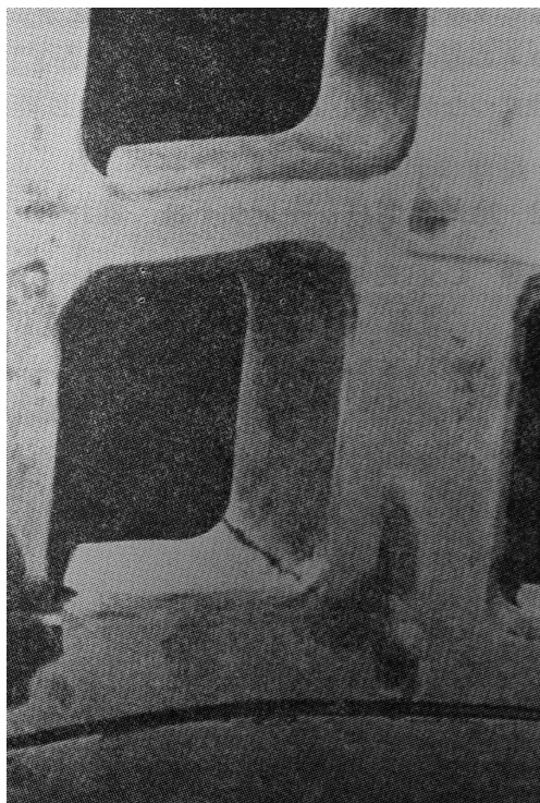
図 63 MAN 大形低速機関シリンダライナ掃気孔下縁部に生じた強い当り痕と亀裂
