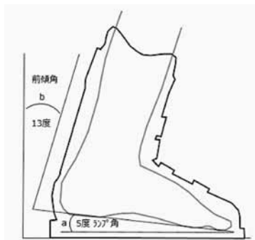
図3 スキーブーツの前傾角とランプ角
