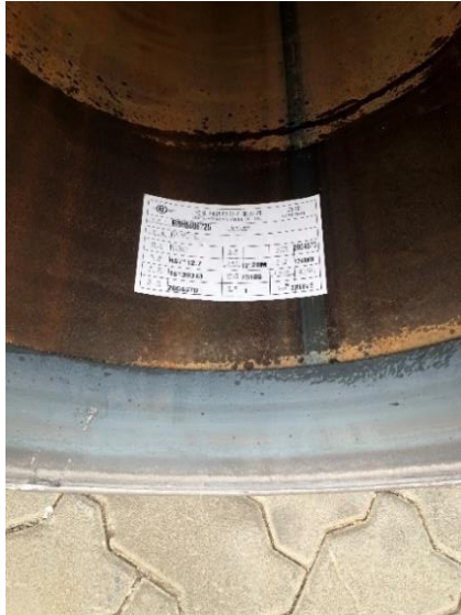
写真 1-6 ラベルの剥がれ・汚損写真
