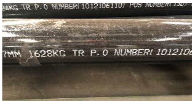
写真 1-3 目視が必要となる鋼管の ID（マーキング）
